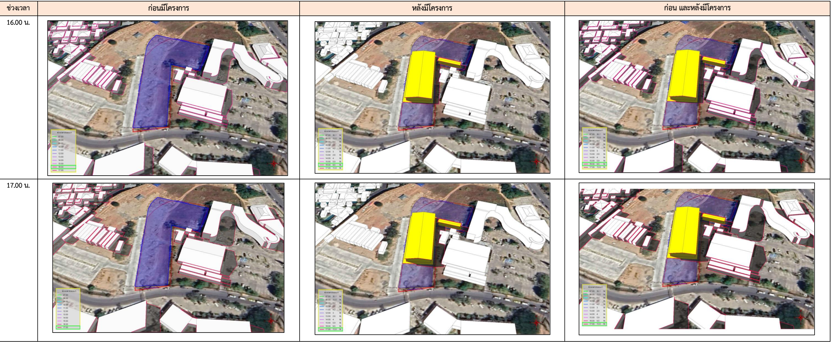
รูปที่ 4.3.8-6(ต่อ) ภาพแบบจำลองการบดบังแสงแดด เดือนมิถุนายน
